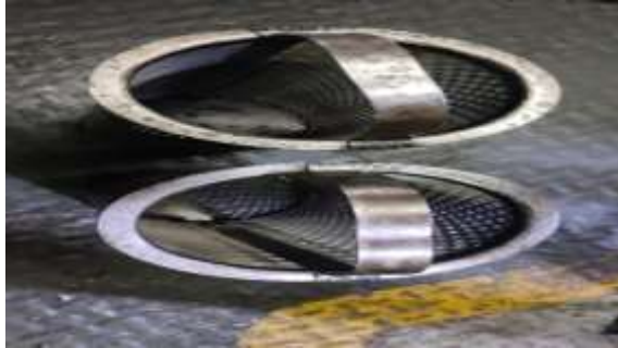
Gambar 3.2 LO Strainer yang telah dibersihkan
