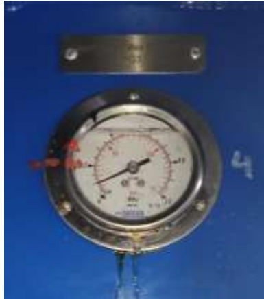
Gambar Tekanan Fine Filter 10 \mu m dan 3 \mu m dalam keadaan normal setelah dilakukan penggantian Fine Filter
