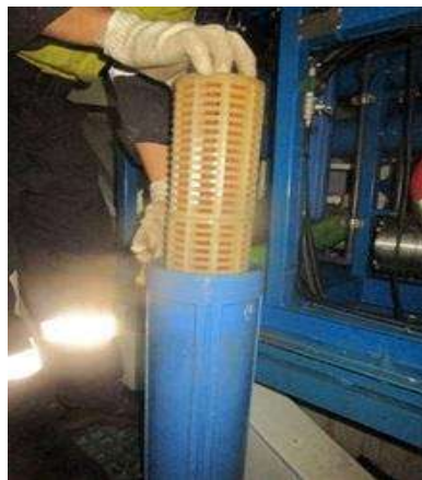
Gambar Kedua Fine Filter yang kotor pada saat alarm high pressure dan high PPM
